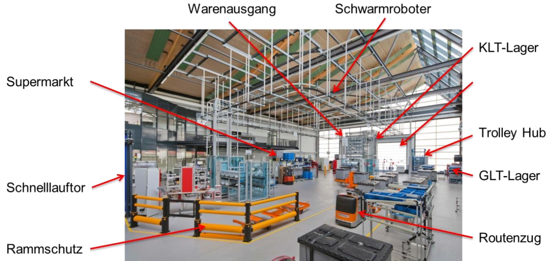
Abbildung: Aufbau Musterfabrik TZ PULS
